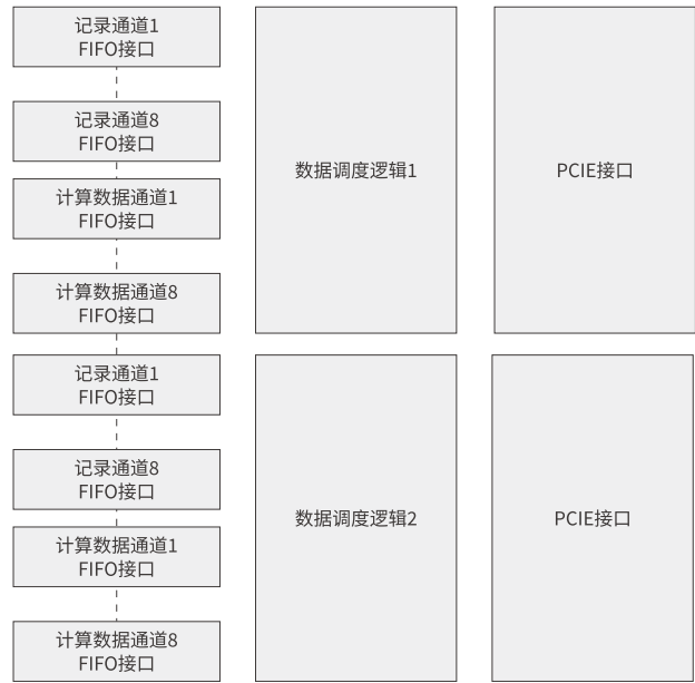
图5 FPGA数据流管理逻辑示意
